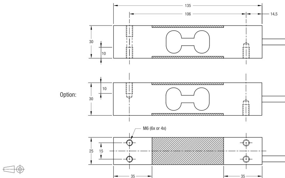
Крепежные болты M6 8.8; усилие 10 Нм. Усилие указано для смазанных креплений.
